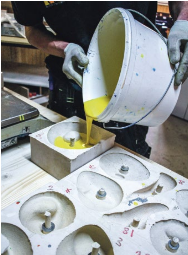
Exaktes Giessen ist bei den Silikonformen für die Klettergriffe gefragt.
